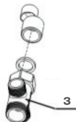
Рисунок 15. Установка переходников для холодной и горячей воды
