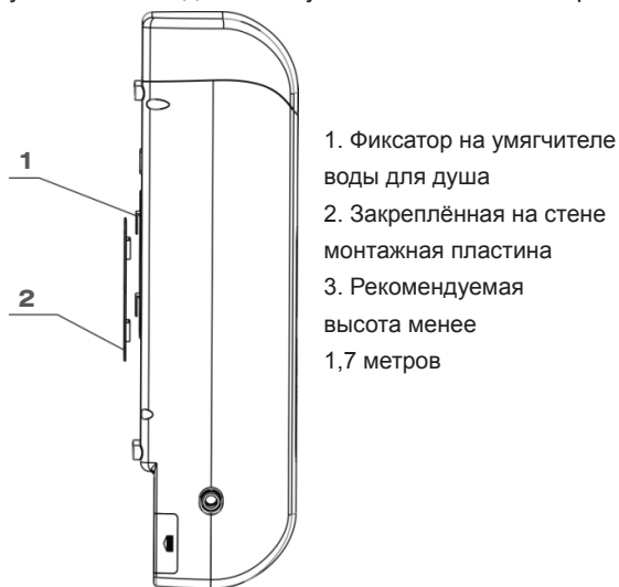
Рисунок 5. Закреплённый на стене умягчитель воды для душа.
